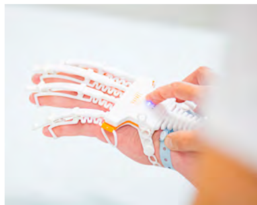
Der Smart Glove wird angesetzt und überträgt gezielt die Bewegungen der Hand in den PC. (Foto: Sebastian Schwarz, fotopxl)
